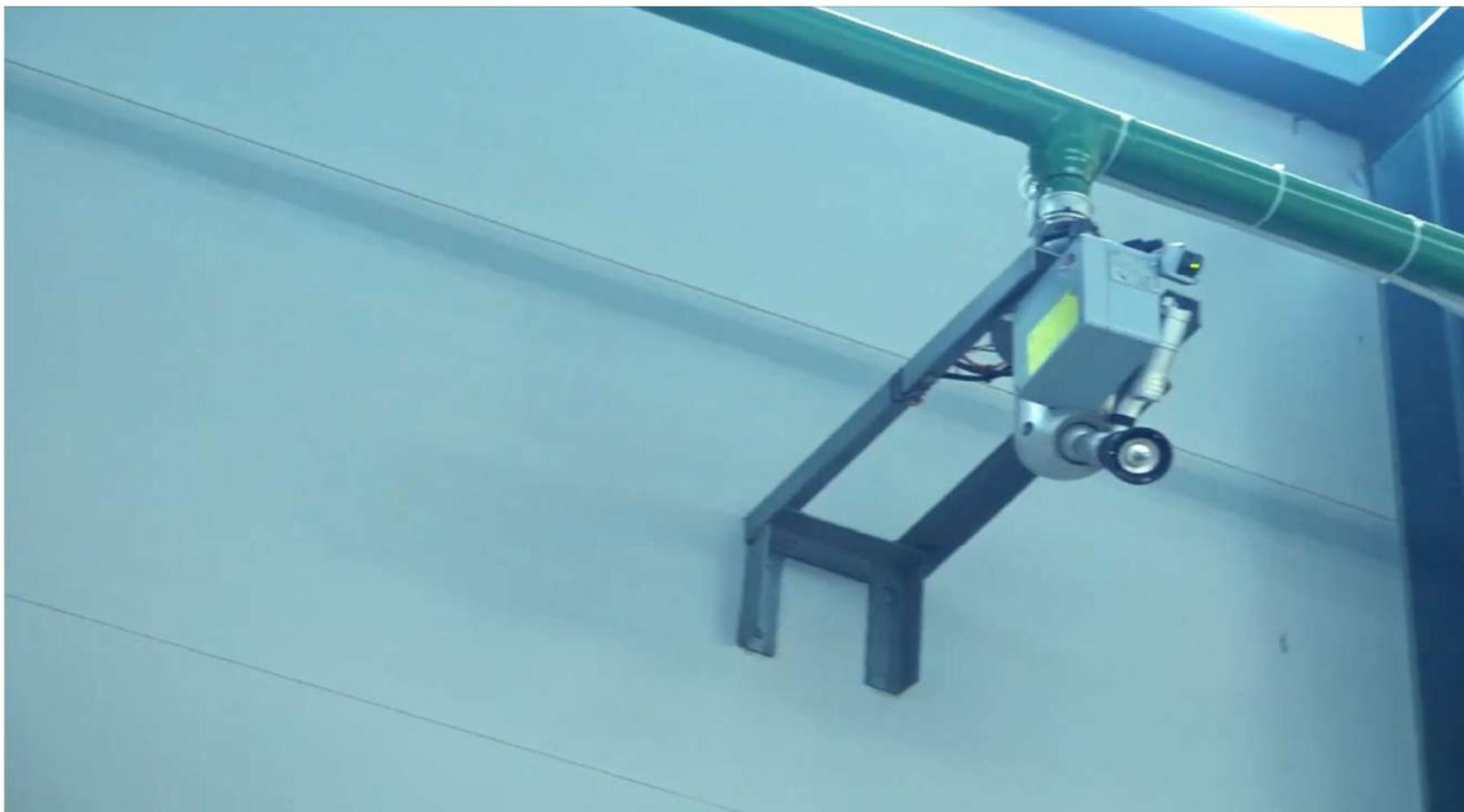
Апробация автоматического обнаружения и тушения модельного очага с ЛВЖ с применением тонко-распыленной воды
