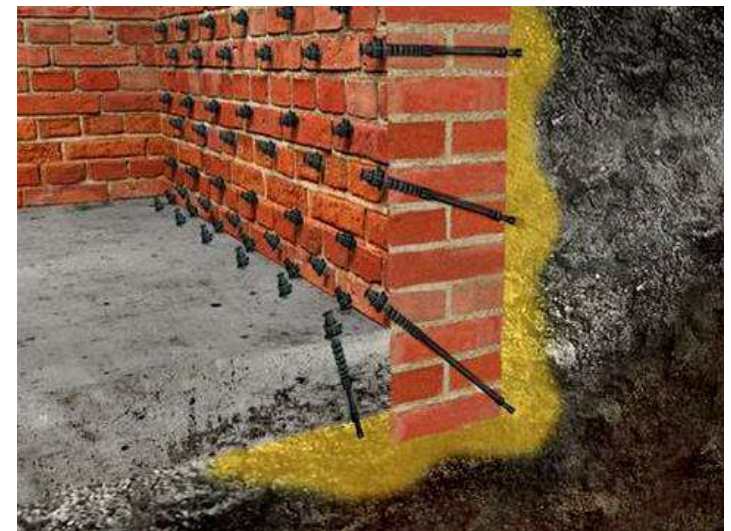
Схема инъектирования контурного пространства
