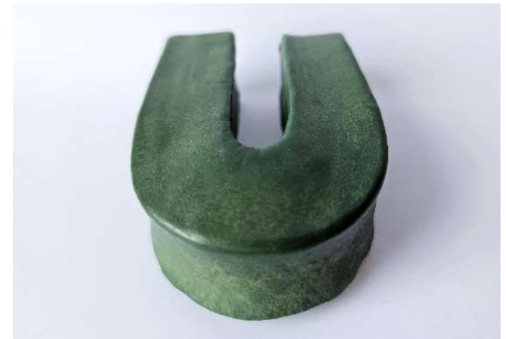
Поворот бентонитового шнура БентИзол® на 180° без появления трещин
