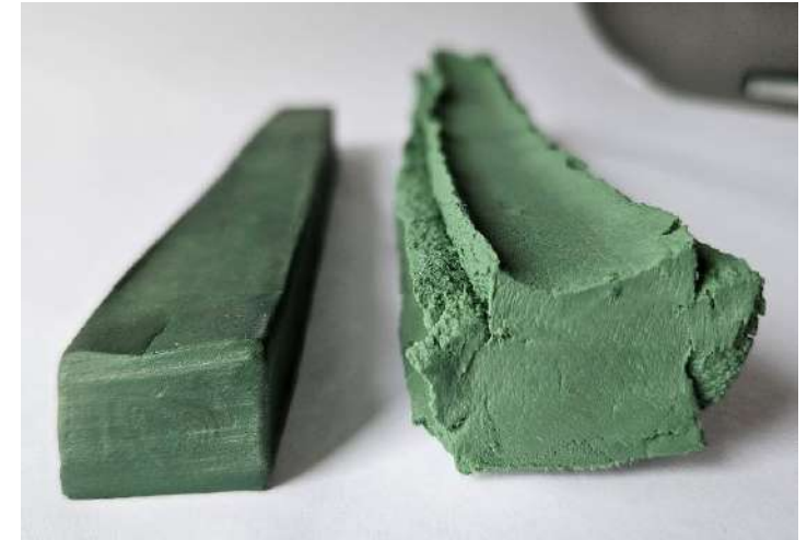
Бентонитовый шнур БентИзол® до и после гидратации
