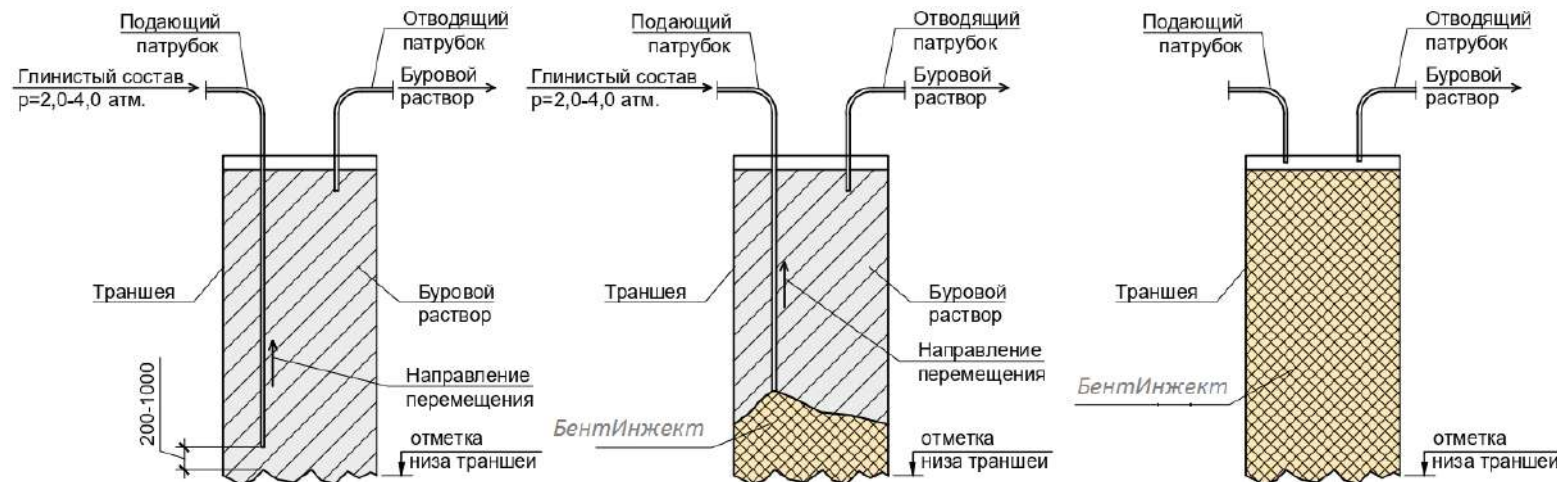
Схема устройства противофильтрационной завесы по технологии «стена в грунте»
