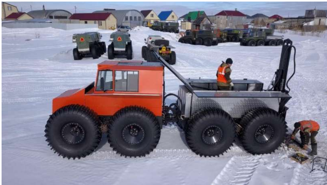
Снегоболотоход Тром 8 оснащенный буровой установкой Т-2, инструмент 1,5м усилие вращателя 400кг/м
