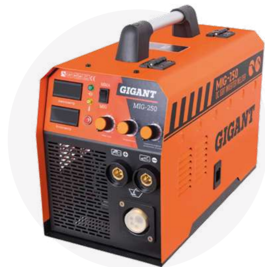
СВАРОЧНЫЙ ПОЛУАВТОМАТ - ИНВЕРТОР GIGANT MIG-250 МАКСИМАЛЬНАЯ МОЩНОСТЬ: 8 КВТ НОМИНАЛЬНОЕ НАПРЯЖЕНИЕ НА ВХОДЕ: 220В ГАБАРИТЫ: 525 X 325 X 380
