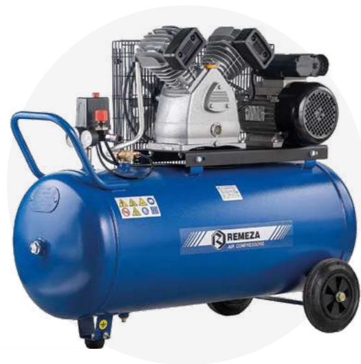
КОМПРЕССОР РЕМЕЗА СБ 4/С-100 LB 30 А ОБЪЕМ РЕСИВЕРА: 100 Л. РАБОЧЕЕ ДАВЛЕНИЕ: 10 БАР ГАБАРИТЫ: 1150 X 850 X 490
